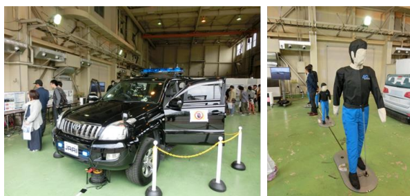
写真5 運転支援システムの試験車両と歩行者模型
