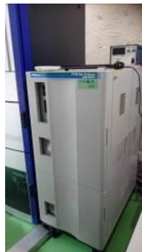
(a) 排気水素計測装置
