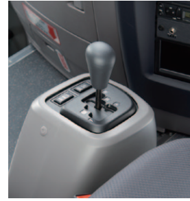
Fig. 17 AMT Lever in the Hino Melpha
