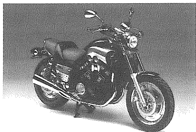
VMAX1200(1989年)水冷4サイクルV4 1197cc 97ps/7000r.p.m
