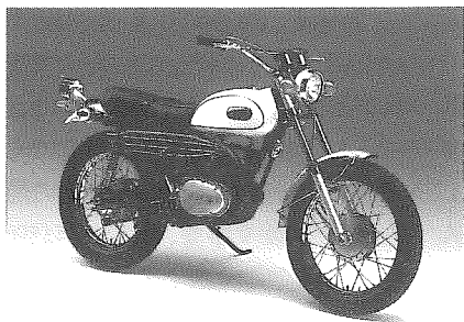
DT-1(1968年)空冷2サイクル単気筒 246cc 18.5ps/6000r.p.m
