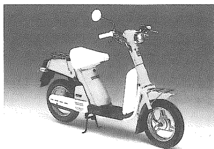
S50パッソル(1977)強制空冷2サイクル単気筒49cc2.3ps/5500r.p.m
