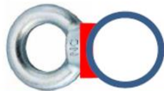
アイボルトの溶接例
