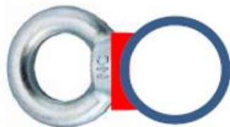
アイボルトの溶接例
