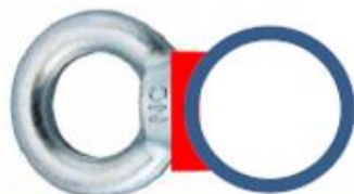
アイボルトの溶接例
